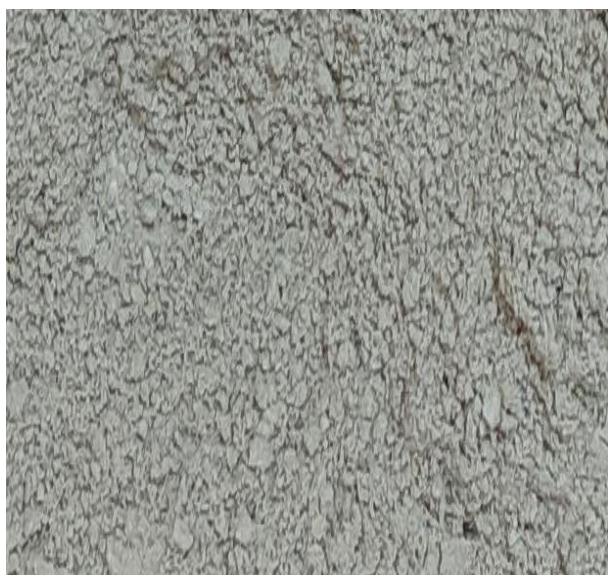
Рисунок 3. Микроструктурные и морфологические исследования показали, что образуется пылевидный рыхлый порошок с размерами частиц примерно 1-100 нм.
