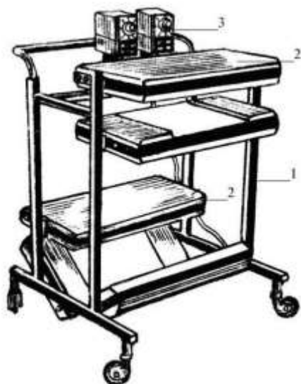
Рис. 6.12. Облучатель ультрафиолетовый длинноволновый для конечностей ОУК-1.
